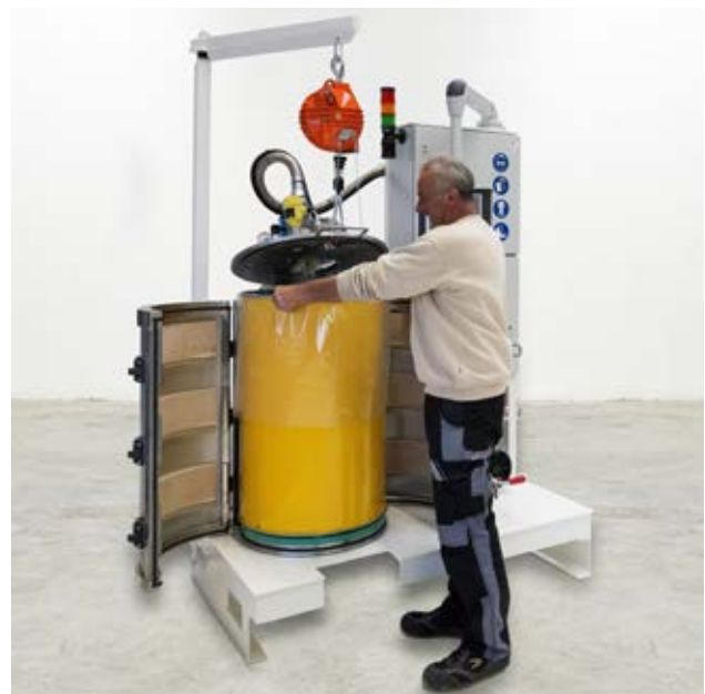
Die Entgasungsstation TAVA 200 F der TARTLER GROUP besteht aus einer Vorrichtung zum Einspannen und Stabilisieren des Fasses, einem Kombiausatz zur synchronisierten Vakuumherzeugung und Befüllung, einer Vakuumpumpe und einer Steuerung mit Touchscreen.
