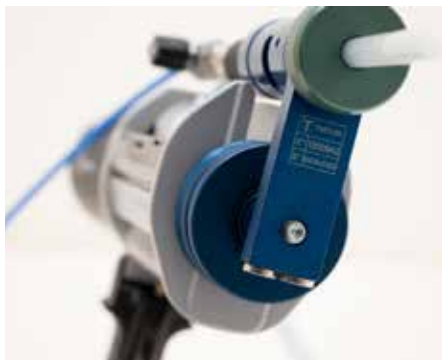
Der Kartuschenmischer wird auf an einer vorhandene Pistole angebracht
