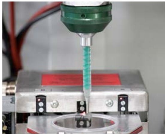
Der Dosiermischkopf LV 2/2 von TARTLER eignet sich serienmäßig zur Verarbeitung von Harzen und Härtern mit Viskositäten von 50 bis 20.000 mPas in Mischungsverhältnissen von 100:5 bis 100:200 Anteilen.
