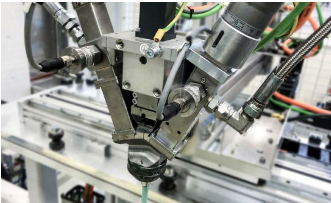
In der Standardausführung ist der Dosiermischkopf LV 2/2 von TARTLER für die Verarbeitung von zwei Komponenten ausgelegt. Er lässt sich aber auch für das Dosieren, Mischen und Auftragen von bis zu vier Komponenten aufrüsten.
