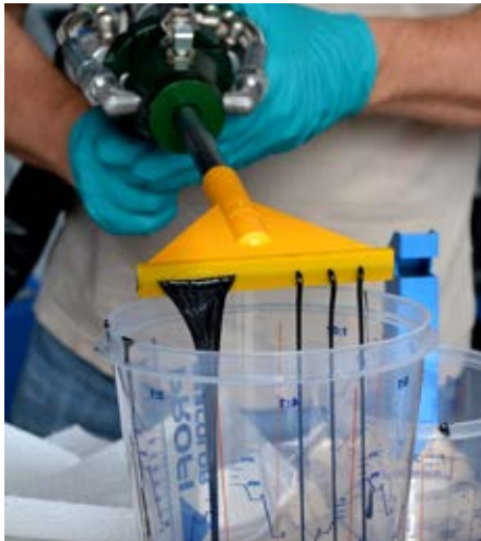
Die Breitstrahldüse wird ohne Adapter und ohne umständliche Klemmvorrichtung auf die Spitze der Mischerhülse gesteckt
