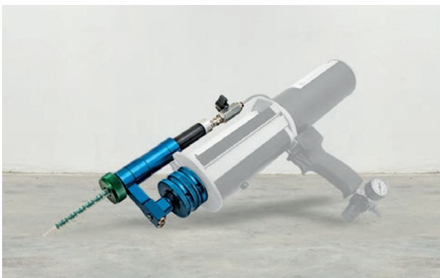
Der Kartuschenmischeraufsatz LC-DCM von TARTLER verfügt über einen Universal-Adapter für zahlreiche marktübliche Dispenser und ermöglicht das dynamische Mischen von Harz und Härter.
