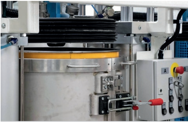
Die TAVA D von TARTLER arbeitet mit einem Vakuumspannfass, das wie eine Vakuumkammer funktioniert. Dadurch kann im Fass ein hohes Vakuum (-0,97 bar) erzeugt werden. Beim Fasswechsel wird keinerlei Luft in das Verarbeitungssystem eingebracht. Materialverlust und Spritzgefahr sind ausgeschlossen.
