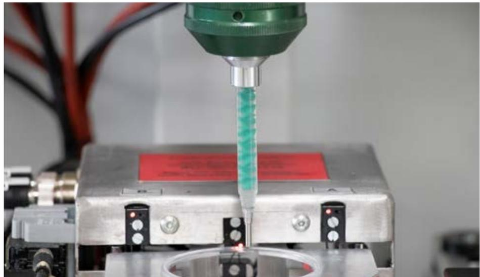
Der neue Dosiermischkopf LV 2/2 von TARTLER ist für die hochpräzise Verarbeitung niederviskoser Komponenten und ihre punktgenaue Applikation in kleinsten Mengen konzipiert. Er ist speziell ausgelegt für anspruchsvolle Qualitätsanwendungen im Elektroverguss und in der Klebetechnik.
