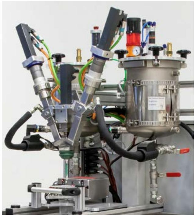
Mit seinem neuen Dosiermischkopf LV 2/2 bietet Anlagenbauer TARTLER eine weitere Innovation für den hochpräzisen und wiederholgenauen Kleinstmengen-Auftrag von Mehrkomponenten-Kunststoffen.
