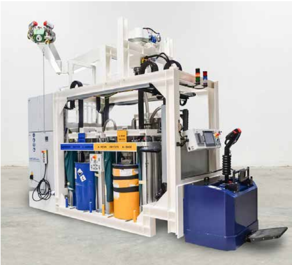
Startklar für den Einsatz in der Windflügel-Herstellung: 2K-Komplettlösung der Baureihe Nodopox von Tartler zur Verarbeitung von zwei hochviskosen Klebstoff-Komponenten. Die Anlage verfügt über eine automatische Nachfüllung aus 200-Liter-Originalgebinden, aus denen das Material in die dahinterliegenden 200 l Edelstahlbehälter gefüllt wird. Dadurch kann gewährleistet werden, dass zum Produktionsstart 200 l Material pro Komponente zur Verfügung stehen. Desweiteren sind Abrolleinheiten für 60 m Luft und Strom, eine Volumenstrom-Steuerung und ein Sechs-Meter-Auslegerarm für den Mischkopf verbaut. Sie verfügt außerdem über eine eigene Antriebseinheit mit Niederflurscanner, protokolliert alle relevanten Projektparameter und stößt bis zu 20 kg/min an gemischtem Material aus.
