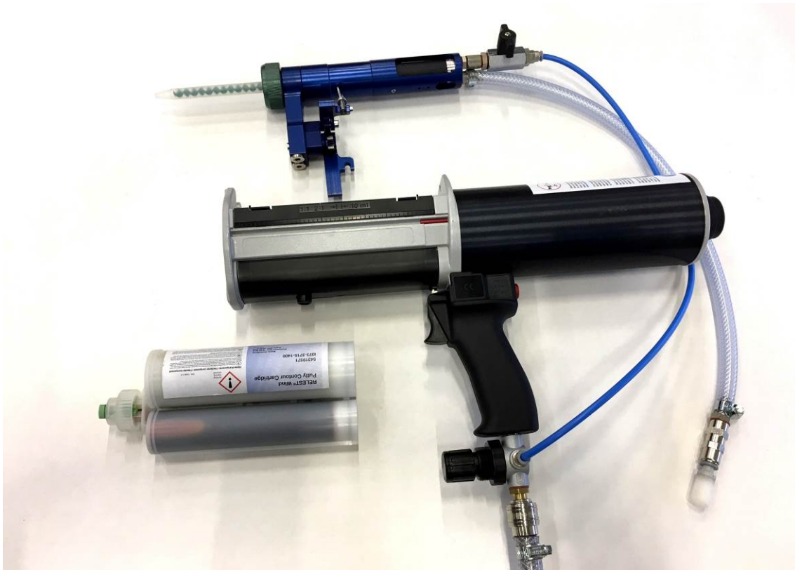
Bild 3: Der neue Mischeraufsatz von Tartler besteht aus einer Flanscheinrichtung zur flüssigkeitsdichten Befestigung eines dynamischen Mixers, einem Drehantrieb zur Übertragung des Drehmoments an den Mixer und einen Adapter für die Verbindung zwischen den Kartuschen und den Komponentenleitungen.
