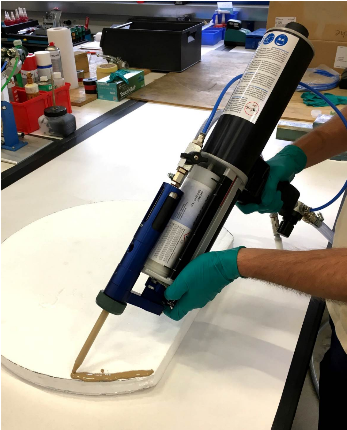
Bild 1: Der neue Mischeraufsatz von Tartler für das dynamische Mischen mit Mehrkomponenten-Kartuschenpistolen hebt die manuelle Kleinmengen-Applikation auf das Qualitätsniveau der hochautomatisierten Großmengen-Verarbeitung.
